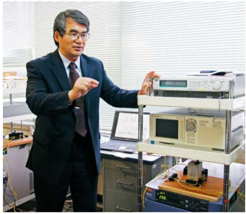
研究室に置かれた恒温槽という装置でバッテリーの性能などを調査
